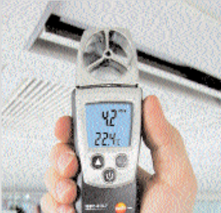
Medición de velocidad en una salida de ventilación con sonda molinete de 40 mm.
