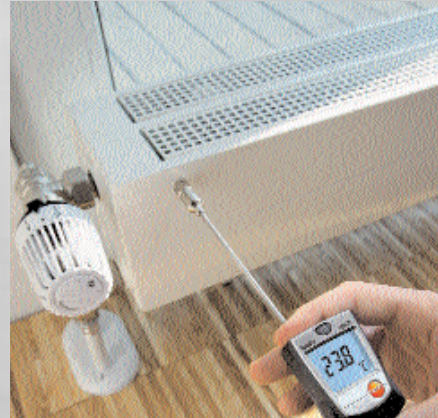
Medición de la temperatura de la superficie de un radiador
