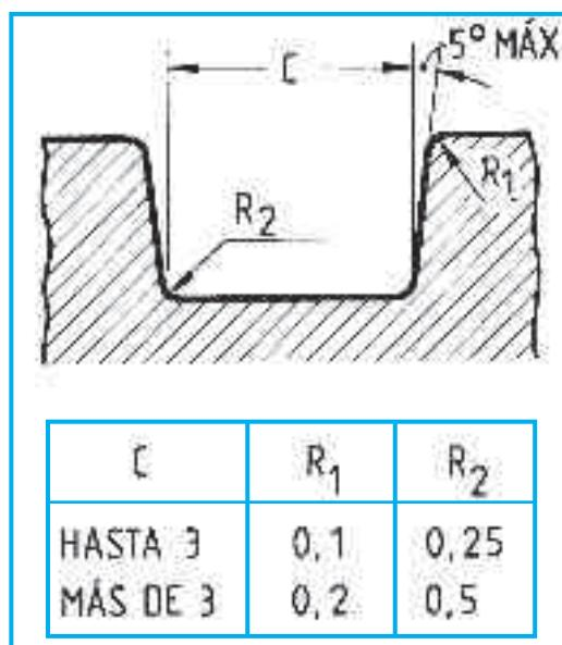
El acero, sobre todo para aplicaciones dinámicas es el material idóneo. El acabado de las superficies fijas y deslizantes deben presentar la menor rugosidad posible, después del mecanizado.
