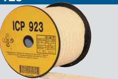
Empaquetadura trenzada con sistema de intertrenzado a base de filamentos de para-aramida impregnados de resina de PTFE y lubricante de rodaje sin silicona.
