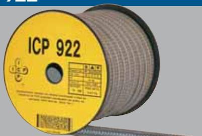
Empaquetadura trenzada con sistema intertrenzado a base de filamentos de PTFE expandido impregnados con grafito sin lubricante, 100% fibra G4® (Gore-Tex®).
