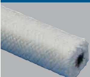
Empaquetadura trenzada a base de hilos sintéticos de alta calidad con interior de elastómero de altas prestaciones y un forro trenzado de filamentos de PTFE.
