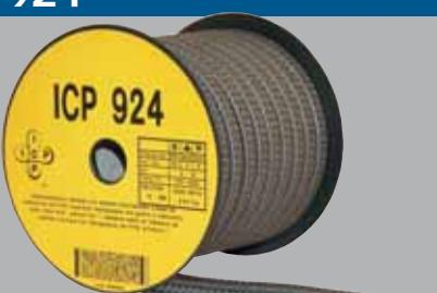
Empaquetadura trenzada con sistema intertrenzado con filamentos de PTFE expandido impregnados con grafito y lubricante, 100% fibra GFO® "Gore-Tex®", doblados sobre un filamento de aramida continua con impregnación de PTFE "Twaron®".
