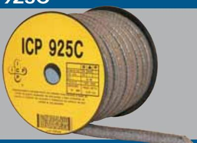
Empaquetadura trenzada mixta con sistema intertrenzado a base de cintas de grafito expandido de alta pureza y bajo contenido en cloruro, inhibidor de corrosión y filamentos de carbono de alta calidad en las esquinas.
